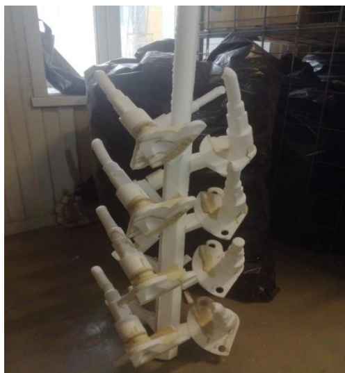
Рисунок 1. Подготовленный к формовке модельный блок детали «валик подъемника»
