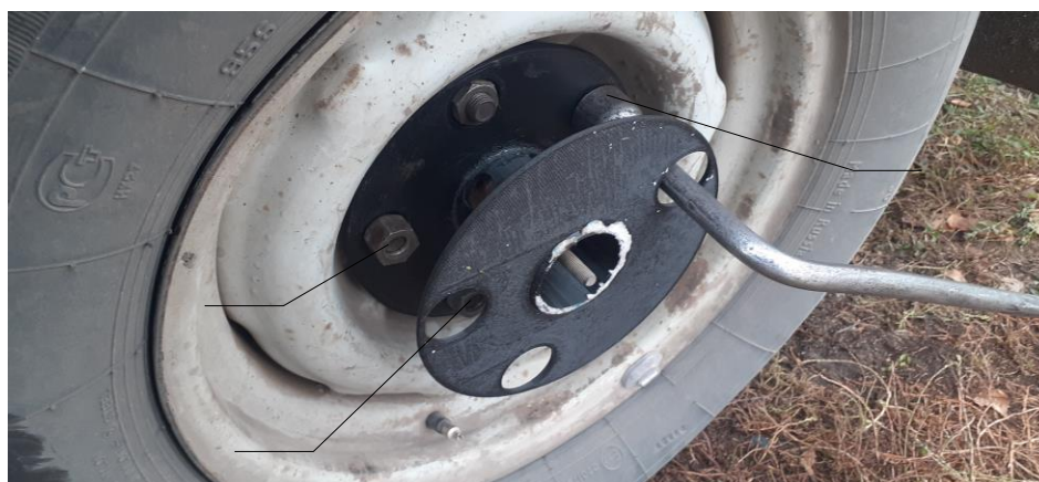
Рис. 8 – Монтаж масштабной модели самовытаскивателя
