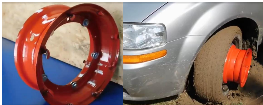
Рис. 4 – Самовытаскиватель из мотороллерного колесного диска
