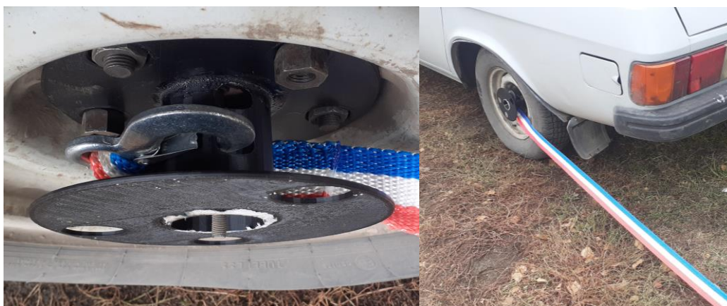
Рис. 9 – Способ крепления буксировочного троса
