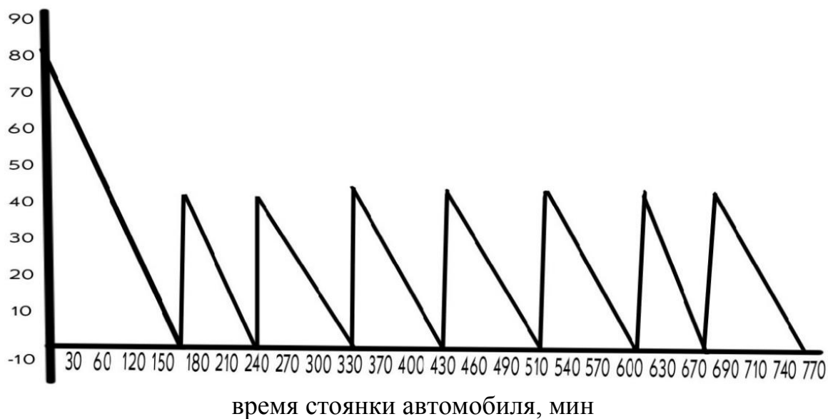
Рис. 5 - Изменение температуры от количества запусков при температурном режиме от 0 до плюс 40 градусов
